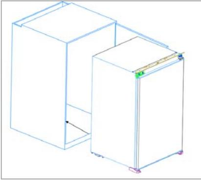
4. Schieben Sie das Gerät so weit hinein, bis die Vorderkante der Gerätefüße auf der Kante des Einbauschrankes aufsitzt (siehe Abbildung). Achten Sie darauf, daß auf der linken Seite zwischen Kühlschrank und Schrank eine Lücke von 5mm bleibt.
