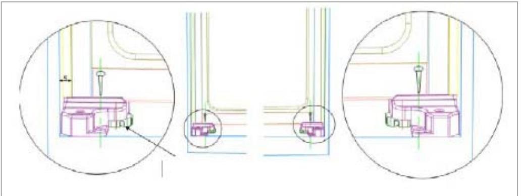
5. Die Gerätefüße sind höhenverstellbar. Die Oberkante des Gerätes muß bündig mit dem Einbauschrank sein. Ist dies nicht der Fall, passen Sie die Höhe der Füße an. Setzen Sie einen Schraubendreher an der vorgesehenen Stelle an (siehe Pfeil obere Abbildung) und drehen Sie je nach Erfordernis nach links oder rechts.
