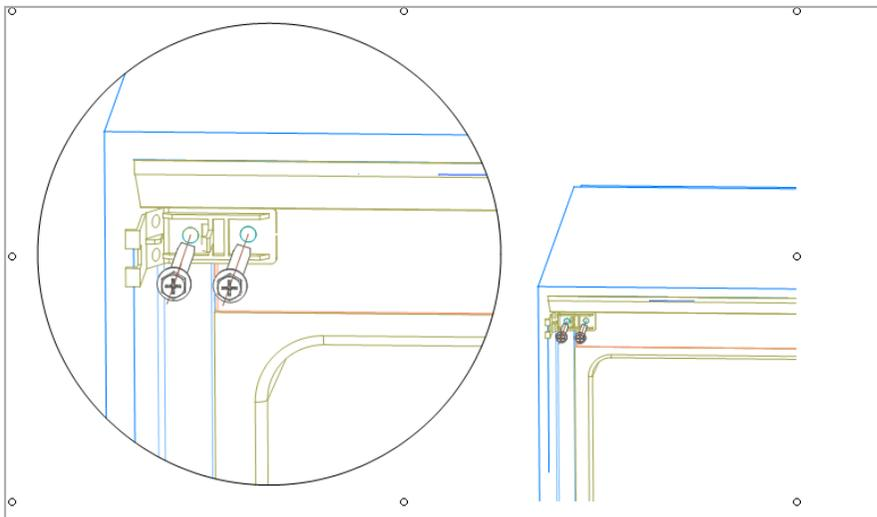
2. Schieben Sie die obere Anschlagleiste in die vorgesehenen Öffnungen auf der oberen, vorderen Kante des Kühlschranks ein.
