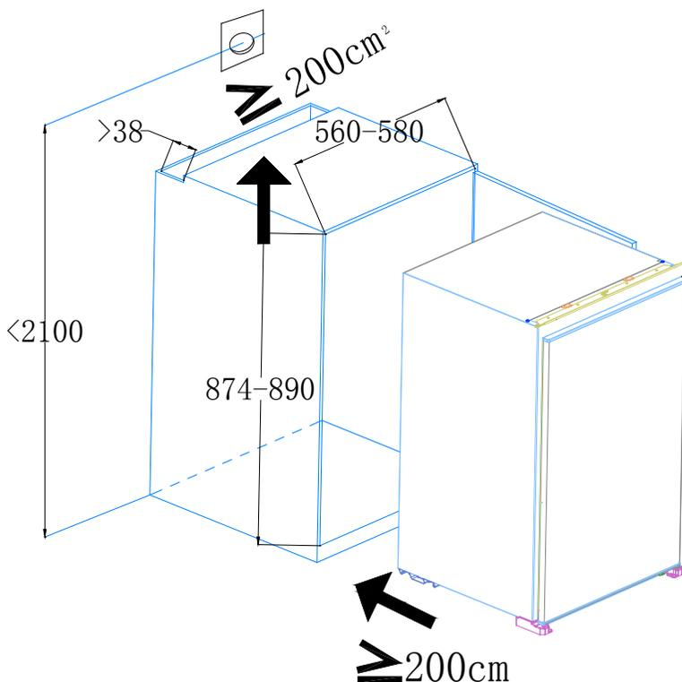
Vor dem Einbau des Gerätes muß der Einbauschränk sorgfältig mit einer Wasserwaage ausgerichtet werden. Die Schrankecken müssen rechteckig sein.
