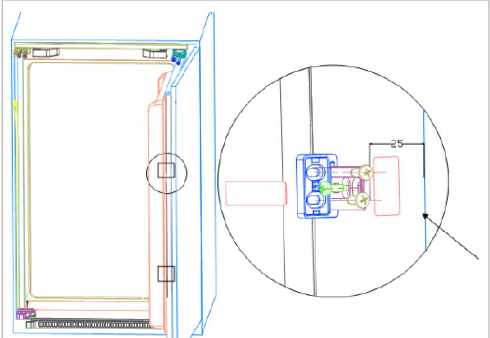
16. Zur vollständigen Befestigung der Schlepptschiene entfernen Sie dann die Führungen und trennen Sie Gerätetür und Möbeltür. Schrauben Sie dann die andere Seite der Schlepptschiene fest.
