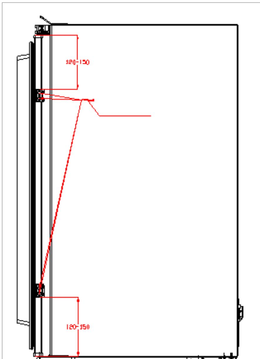
14. Befestigen Sie die Schlepptschienenführungen mit vier ST 4 x 12 Schrauben auf dem Rand der Kühlschranktür. Drücken Sie die Gerätetür an die Möbeltür.
