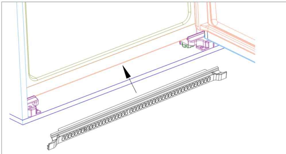
12. Befestigen Sie nun auf der linken Seite das Kederband zwischen Kühlschrank und Einbauschrank, um die vorhandene Lücke abzudecken.
